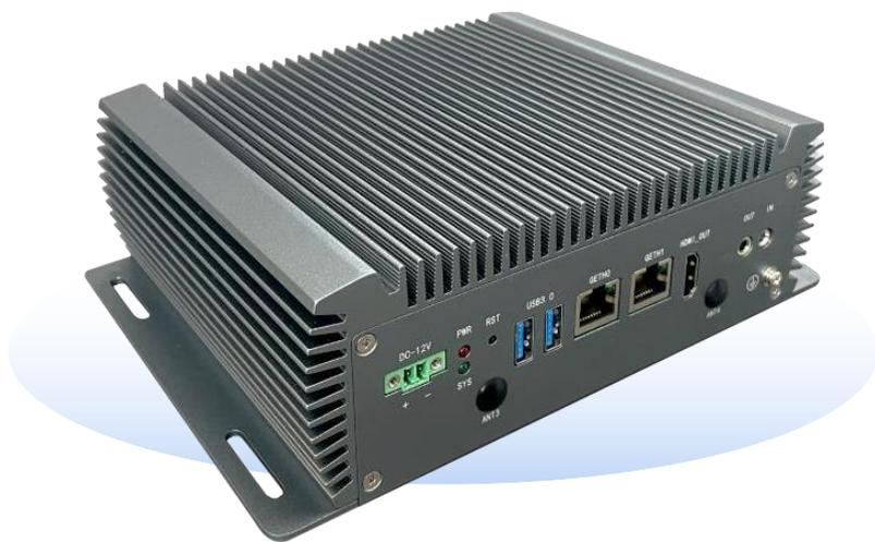
**DA160S** 搭载高集成智能视觉深度学习芯片BM1688，处理器为 8 核 ARM CA53，主频1.6GHz，算力高达**16TOPS@INT8**，支持 16 路高清视频智能分析，支持混合精度运算，具备高性能、低功耗、外设接口全、环境适应性强等特点，通过搭配多样化深度学习算法，灵活应对智慧城市、智慧商业、智慧能源等场景，实现边缘侧的数字化赋能。
