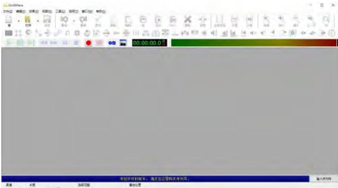
2.2、导入音频文件（文件——打开——选择音频存放路径，软件底部最后一栏可以看到音频一些 基本信息）：**（声卡支持采样率为 44100Hz）**
